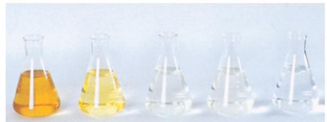
主処理水 凝集沈殿処理水 オゾン脱色処理水 ろ過処理水 放流水
